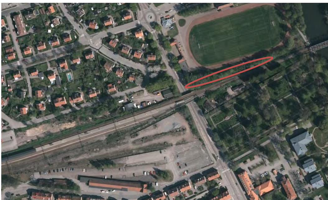
Figur 12. Förslag på placering av makadamdike för fördröjning och rening av dagvatten från Brunnsgratan.
